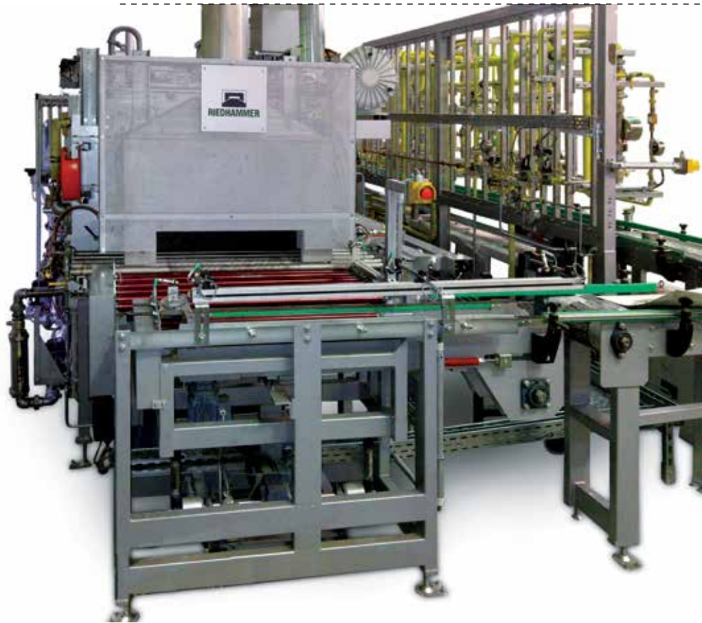
Furnace entrance with exhaust hood and close-loop conveyor. Ingresso forno con cappa di aspirazione e convogliatore a circuito chiuso. Ofeneingang mit abzughaube und geschlossenem förderkreis.
